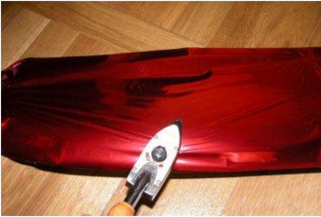
On suit le bord de l'aile en chassant le plus possible les plis.
