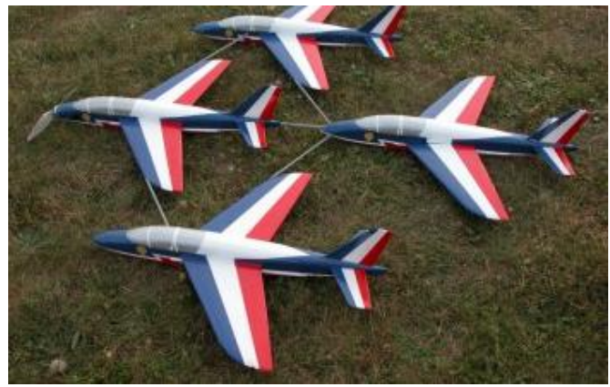
Patrouille de France. Entoilage difficile réalisé après construction. Plus de 120 morceaux de film ont été posés...
