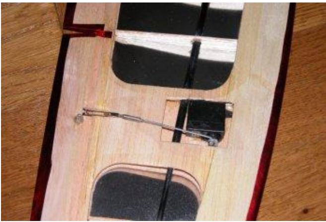
L'entoilage de l'intrados a été réalisé sans retirer les servos d'ailerons.
