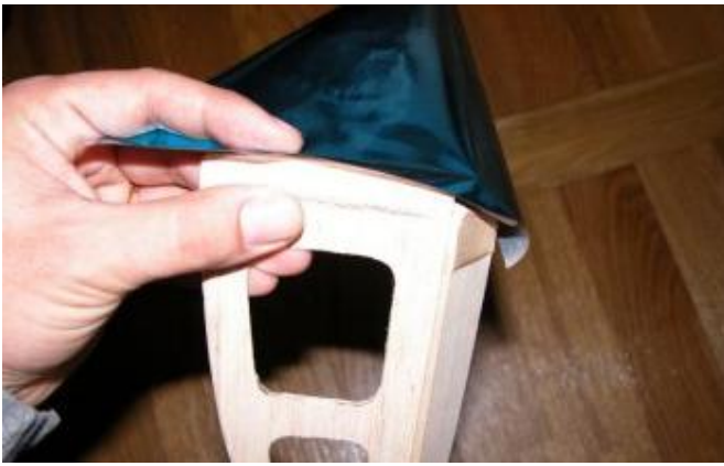
Pose du film côté intrados. Le film dépasse légèrement côté emplanture.
