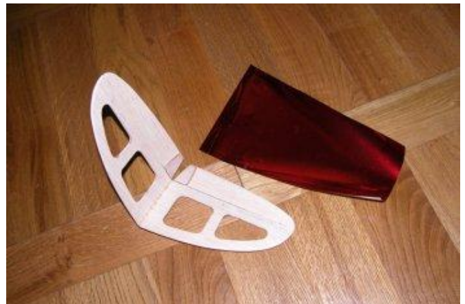
Ici, le stabilisateur en V est déjà assemblé. Les gouvernes sont également en place avec leur charnières en toile.
