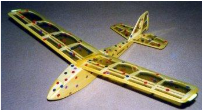
Confetto. Les points sont découpés à la perforeuse d'écolier dans l'Oracover.
