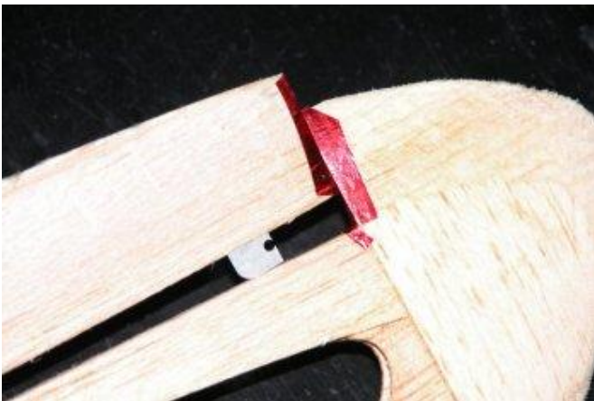
Mise en place de l'aileron dans l'aile.
