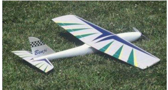
Benji. Entoilage nacré. Le damier de la dérive est réalisé avec des petits carrés d'entoilage.
