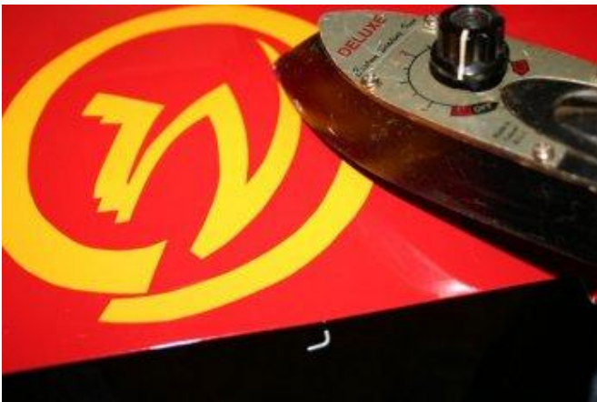
On pose le décor à la pointe du fer, sans trop chauffer.
