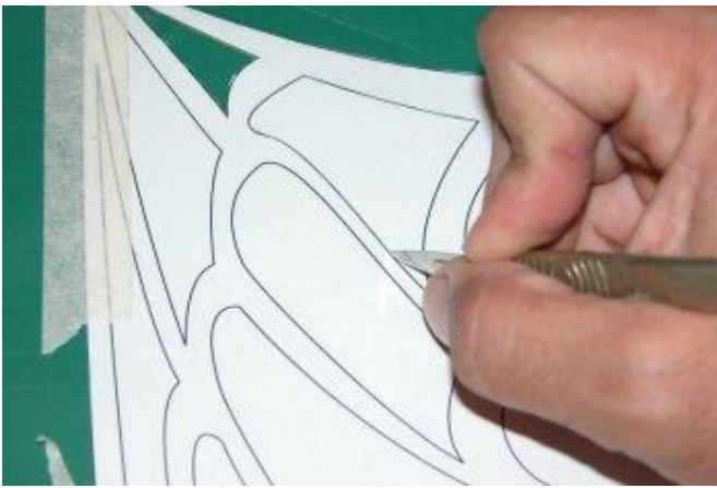
Un scalpel est parfait pour les courbes prononcées.
