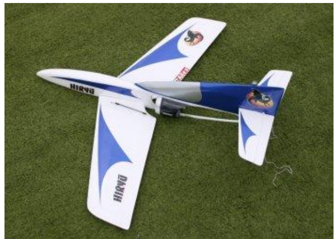
Hiryù. Entoilage sur structure ajourée et coffrée. Les logos imprimés sur papier sont ensuite recouverts avec de l'Oracover light incolore.
