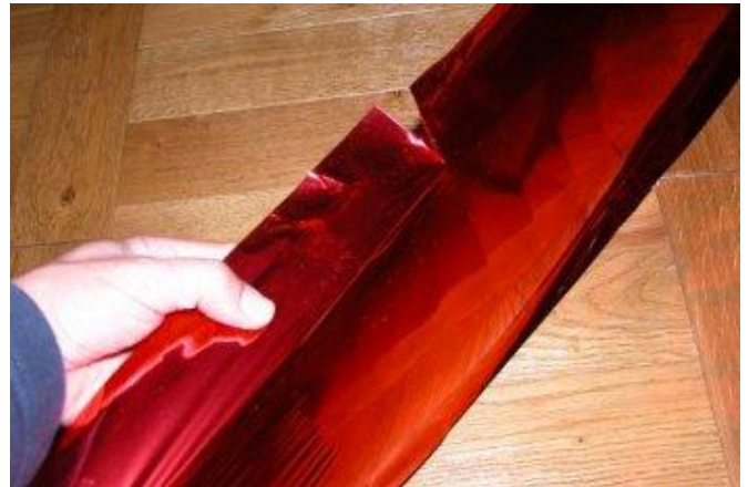
On plaque le film au niveau de la charnière puis on recouvre la gouverne.
