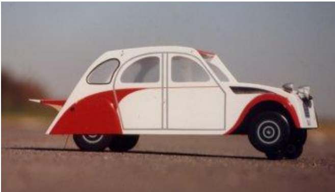
Deudeuch (volante, bien sûr !). Les "vitres" sont en Oracover incolore. Pour accentuer le relief, les pneus sont en noir nacré tandis que l'intérieur des garde-boue est en noir classique.
