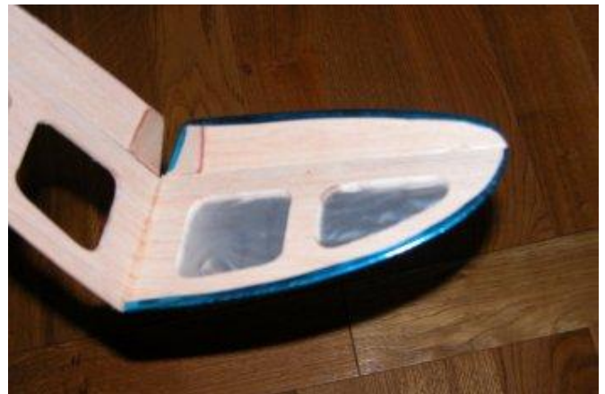
Pour cette étape, on peut chauffer plus fort de manière à bien plaquer le film tout autour.
