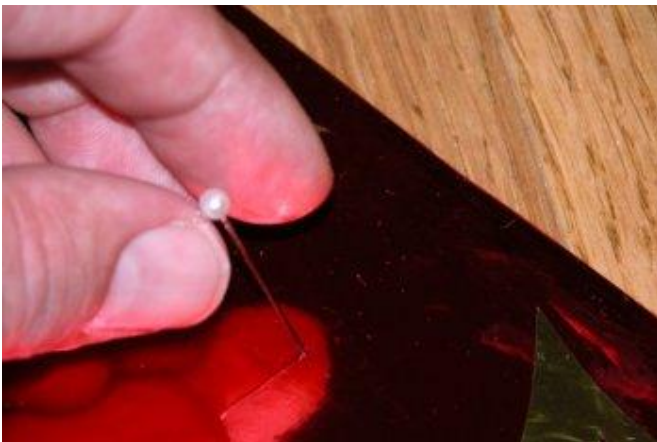
Il faut bien sûr repérer par tâtonnement les éléments à ajourer. Ici, le passage de la vis.
