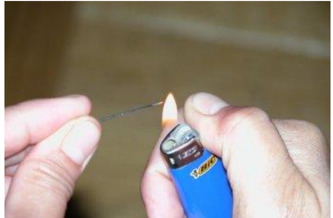
Une épingle chauffée est très efficace pour percer le film. La tête de verre évite de se brûler les doigts...
