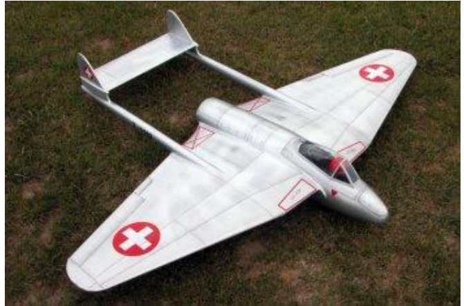
Vampire. La voilure est entoilée à l'Oracover noir puis peinte et vieillie. Les lignes de structure ressortent après grattage avec une pointe.
