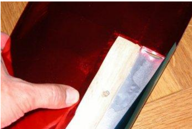
L'aileron est plaqué sur l'extrados de manière à bien assurer la charnière.
