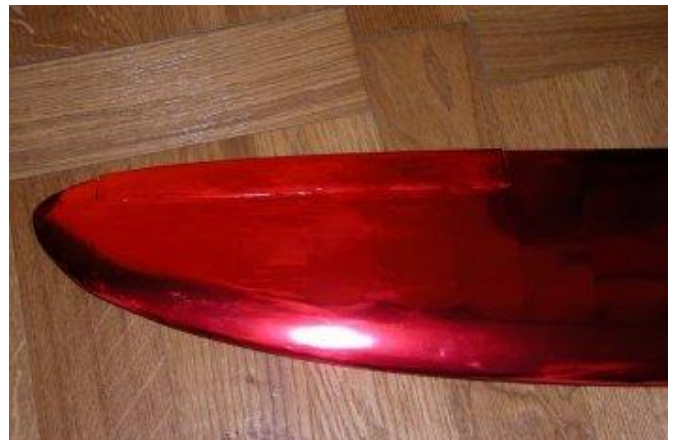
Quand les bords sont entoilés, le film peut être tendu sur toute la surface.
