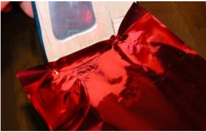
Sur le dessus, le film déborde d'environ 1 cm sur l'autre demi-stab.
