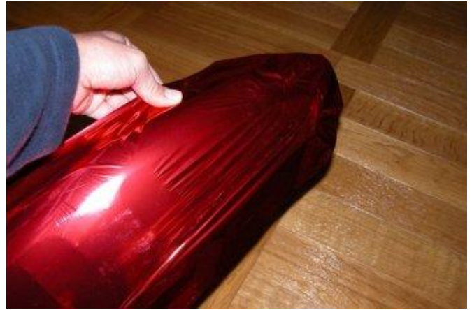
Le collage se fait sur les parties coffrées. Les parties ajourées seront tendues plus tard.
