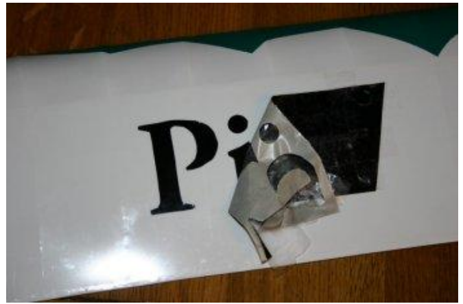
La dépouille est retirée avec délicatesse tandis que les lettres sont plaquées sur l'entoilage.
