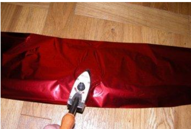
On commence par plaquer le film au centre de la pièce à recouvrir. Le fer ne doit pas être trop chaud.
