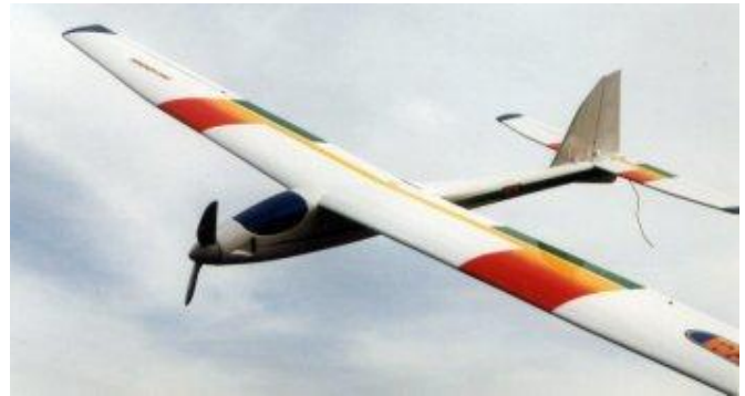
Don Shimoda. Le décor est posé à la peinture en bombe sur l'entoilage, après masquage.
