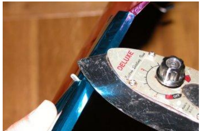
Bien plaquer le film contre les champs au niveau de la charnière.
