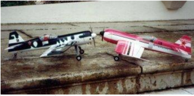
Sukhoï 26. Les décors existants sont réalisés à l'aide de gabarits découpés sur mesure.
