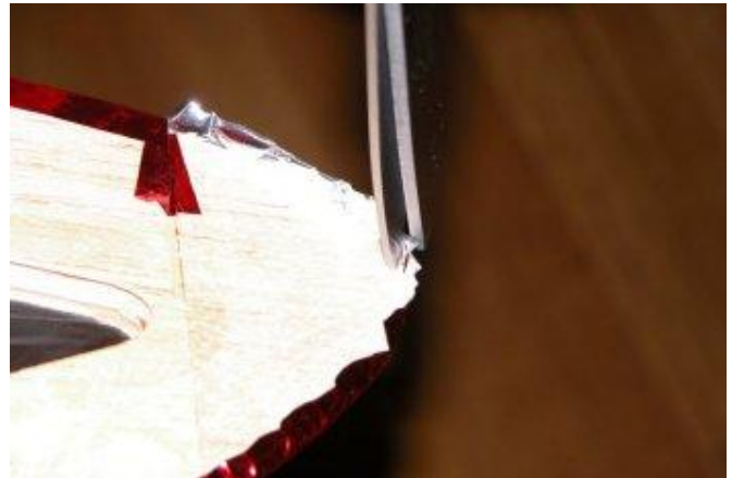
Dans les arrondis prononcés, il faut réaliser des entailles pour bien plaquer le film.
