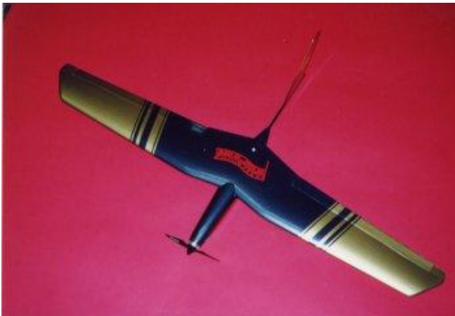
Speed-Wing. Entoilage sur cellule intégralement coffrée, noir nacré et or.
