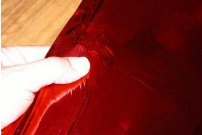
L'aileron est plaqué vers le bas pendant le collage le long du bord de fuite.
