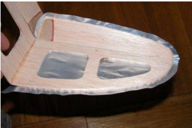
Le film est découpé légèrement plus grand que les éléments à recouvrir.
