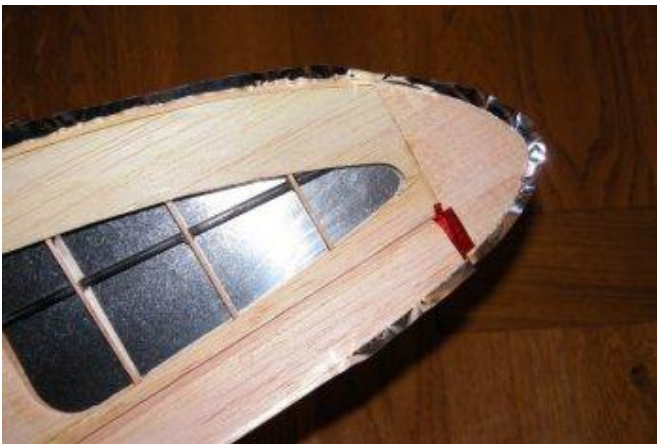
Prévoir tout autour de la pièce entoilée un débord de 5 mm .
