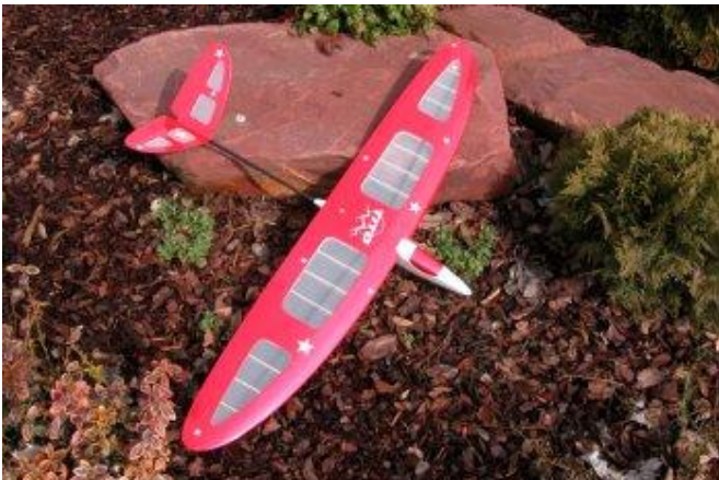
Tito. Film translucide et rouge. L'incolore est posé en premier. Les ouvertures dans le film rouge sont réalisées à l'avance, à l'aide d'un gabarit ajouré.
