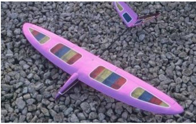
Titoletta. Entoilage light et chrome. Les intervalles entre les nervures sont entoilés séparément. Un filet blanc vient augmenter le contraste.
