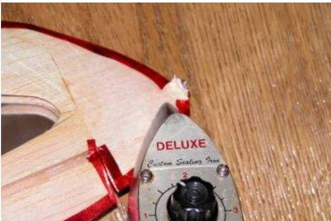
Les languettes sont plaquées les unes après les autres. On peut chauffer fort.
