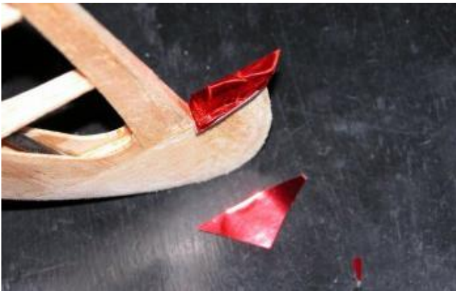
On entoile les chants extérieurs des gouvernes et des parties fixes en premier, séparément.
