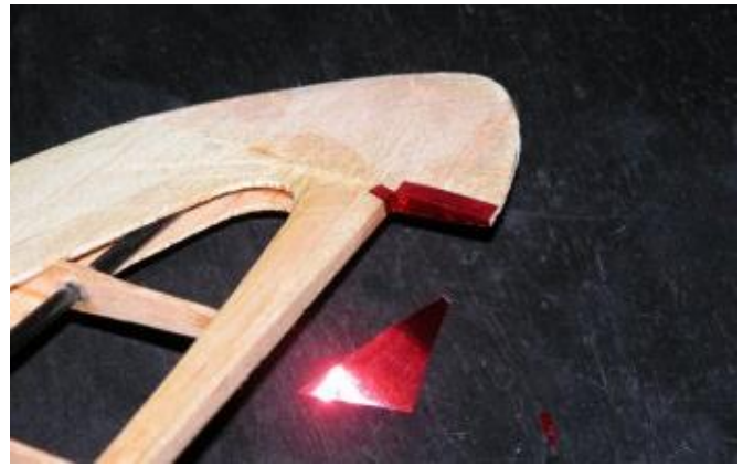
Le film replié déborde sur quelques millimètres. Ainsi, on ne risque pas de voir apparaître le bois.
