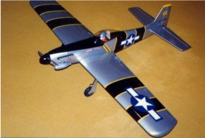
Mustang. Entoilage au gris métallisé, bien plus facile d'emploi que le chrome qui laisse ressortir le moindre défaut.
