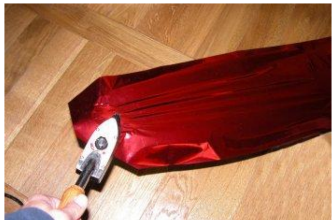
Ensuite, on tend le film bien dans l'axe et on le plaque aux extrémités.
