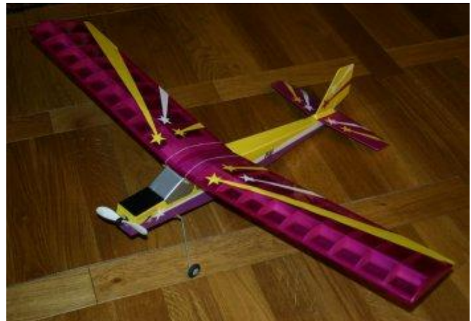
Elektro-Piaf. Mélange de film transparent et opaque.
