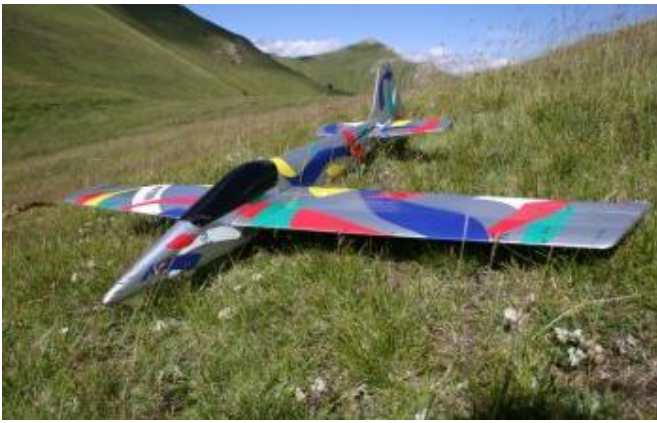
Madslide. Décor rapporté sur le fond gris, découpé à l'aide de gabarits imprimés sur papier.
