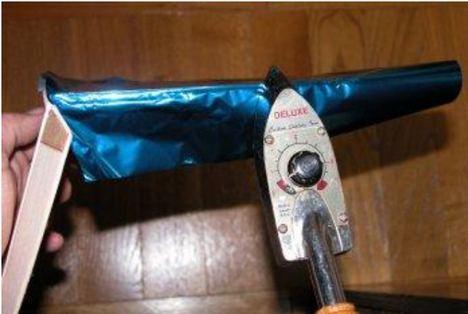
Là encore, il faut bien insister au niveau de la charnière, en rabattant la gouverne.
