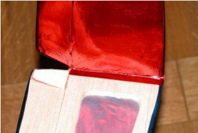
On voit bien ici la partie qui déborde et qui sera recouverte en entoilant l'autre face.
