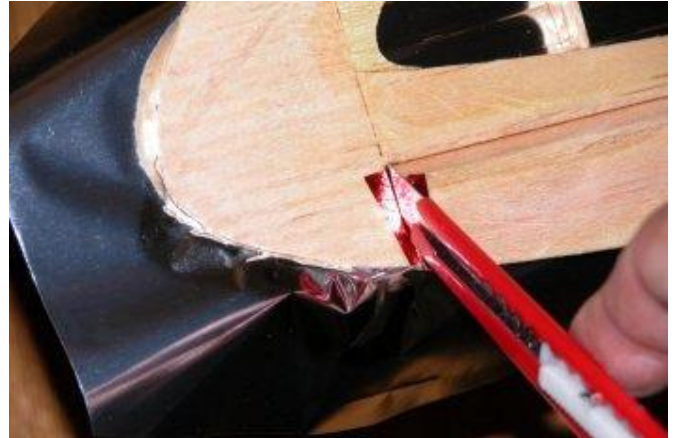
Une lame de cutter glissée par l'intérieur dans la fente permet de couper le film avec précision.
