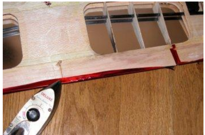
Plaquier le film le long des champs puis sur l'autre face à recouvrir.
