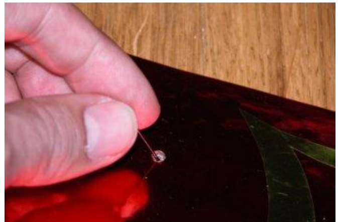
Il peut être nécessaire de s'y reprendre à deux fois. Le film fondu colle parfaitement autour du trou.
